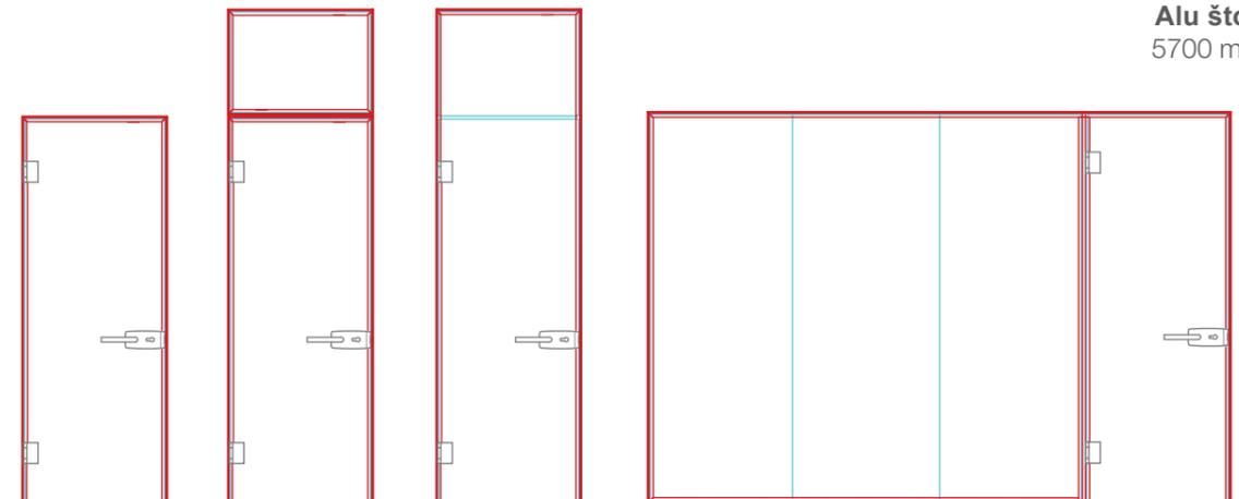
Moguća je primena za fiksno staklo pored ili iznad vrata kao i za fiksno staklo iznad vrata sa ili bez horizontalne prečke.
